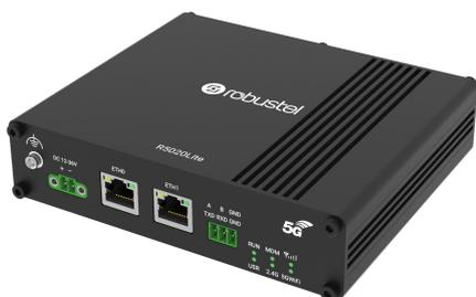
R5020 Lite 是鲁邦通推出的新一代 5G 路由器，支持 5G 独立组网（SA）和非独立组网（NSA），同时支持国内三大运营商的 5G 网络，在没有 5G 网络的情况下，也能使用 4G 和 3G 的网络，为物联网设备和传感器提供高带宽、低时延、高可靠的无缝无线网络连接。
